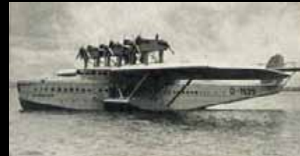
Il Dornier DO X, dotato di 12 motori, capace di trasportare 100 passeggeri.
