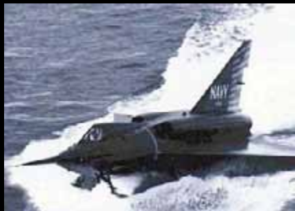
Il Convair XF2Y-1 "Sea Dart" con motori a reazione, unico idrovolante ultrasonico mai costruito.
