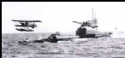
Il Parnall "Peto" decolla dallo scivolo di un sottomarino, in cui viene stivato; la gru serve per issarlo a bordo.
