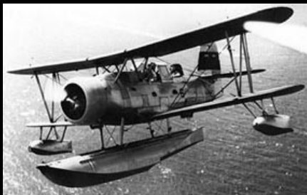
Curtiss "Seagull Scout", esempio di idrovolante con un galleggiante centrale e galleggianti alari.
