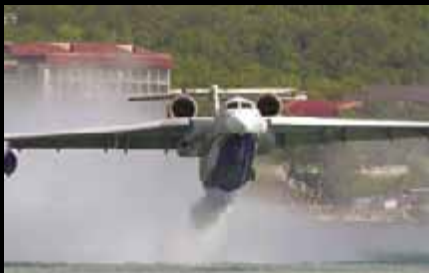
Beriev 200, destinato al trasporto di passeggeri e servizio antincendio, esempio di idrovolante a scafo.
