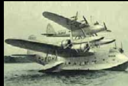
Lo Short-Mayo composite, formato da due idrovolanti, destinato a far giungere quello in alto a mete lontane.
