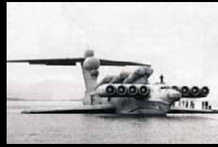
Un ekranoplano russo militare, curioso aeromobile che vola in effetto-suolo.
