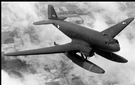
C-47 / DC3 su galleggianti prodotti dalla Edo, esempio di idrovolante con galleggianti.
