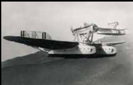
Savoia Marchetti S-55, l'aereo delle crociere di Balbo, esempio di idrovolante a doppio scafo.
